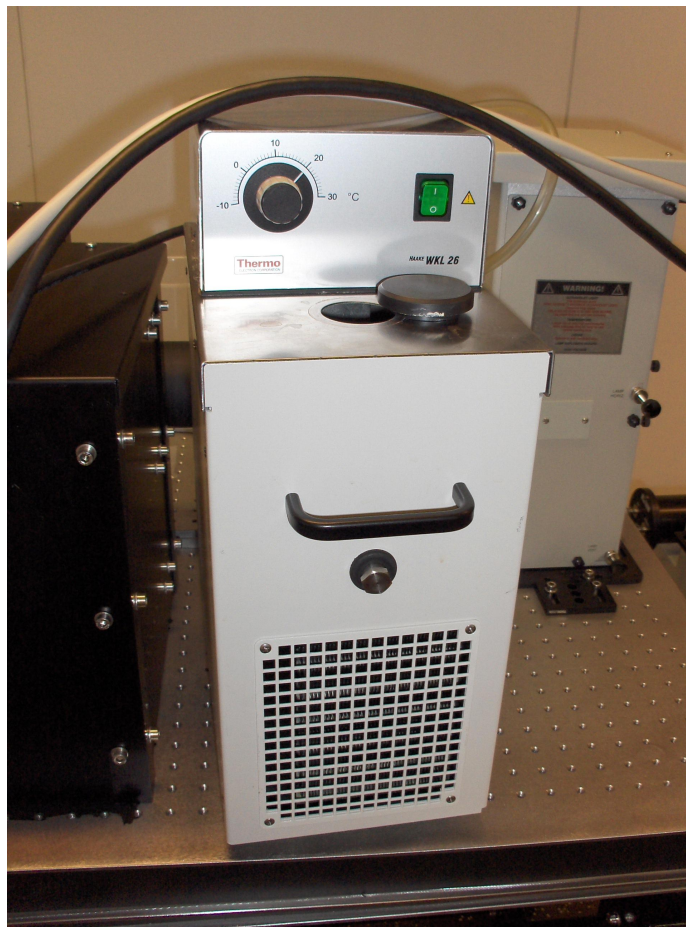
Kuva 9. Kiertovesijärjestelmän jäähdytysyksikkö. Vettä lisätään yläosassa näkyvästä muovitulpan alla olevasta reiästä. Keskellä etuseinää oleva mutteri on veden poistoaukko.
