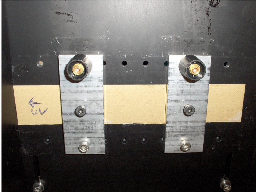
Kuva 6. Näytteestä merkataan vasen laita joko tekstaamalla tai viistämällä vasen ylänurkka. Näytteen asennon identifiointia tarvitaan myöhemmin näytteen analysointivaiheessa.
